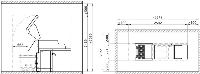
Der Arbeitsbereich um die Maschine herum beträgt allseitig min. 0,5m, für Wartungsarbeiten min. 1m und wenn dieser als Durchgangsweg verwendet wird min. 1,2m.
